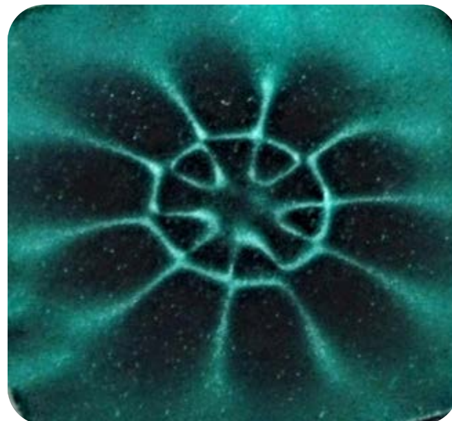
Abbildung 4: Feldlinien im Werkzeug
