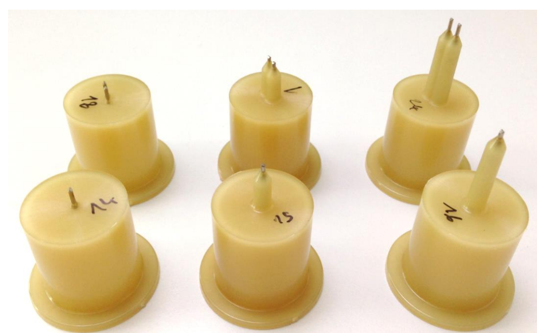
Prototypes de test avec variation de la longueur de surmoulage.
